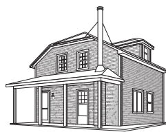
La maison à toit en demi-croupe ;
